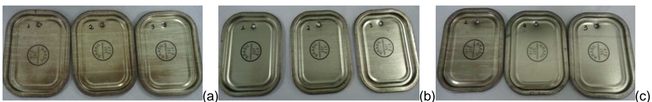
FIGURA 5. Fotografias ilustrando a face externa das tampas nos diferentes tratamentos (a) 121 °C/80 min, (b) 110 °C/120 min e (c) 125 °C/65 min.
