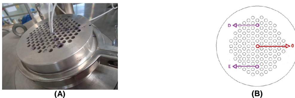
Figura 2. Esquema do posicionamento das fibras ópticas em relação à tampa do cesto de teflon.
