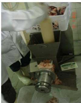
**Figura 2.** Desossadora tipo anéis
