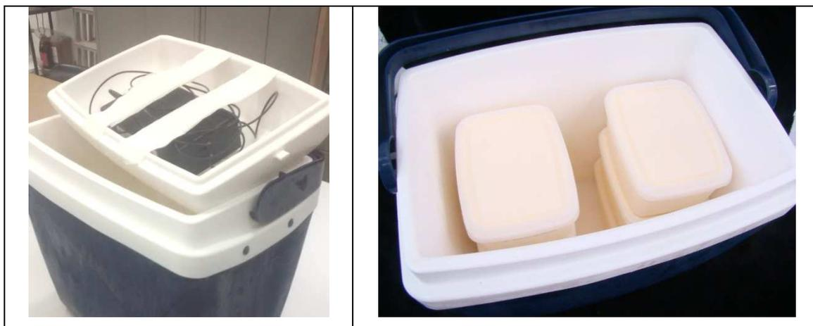
**FIGURA 1.** Caixa térmica contendo produto com o dispositivo fixado na tampa.
